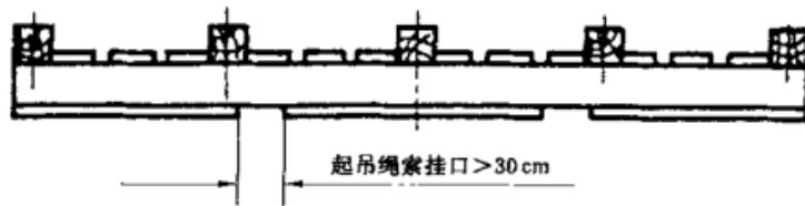
图 9 采用5根及以上枕木的A型底盘吊装位置示意
